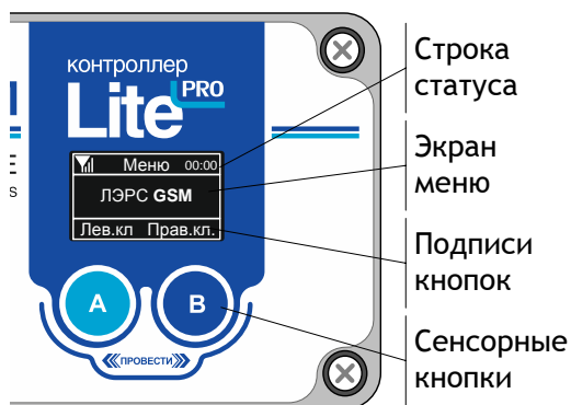
Рисунок 5. Дисплей контроллера LitePro
