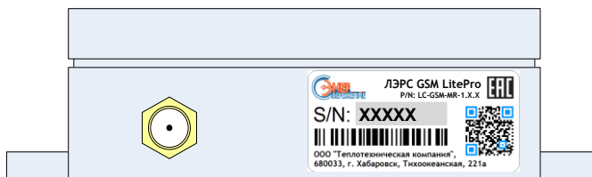
Рисунок 6. Место расположения маркировки LitePro
